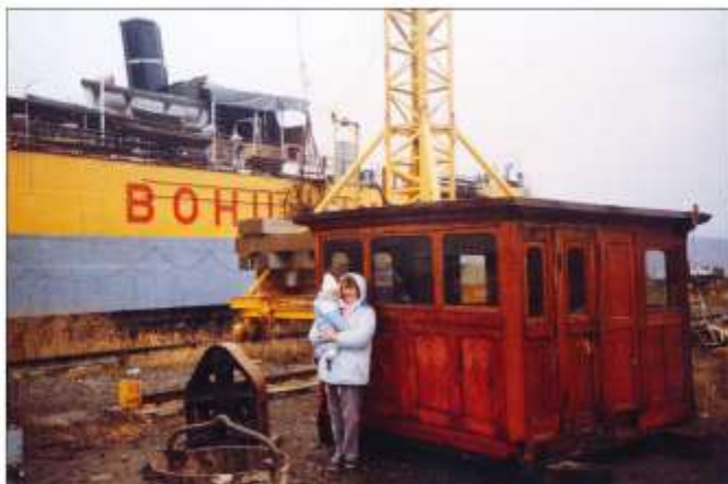
Bohuslän s styrhytt och styrstativ har lyfts iland inför bytet av bryggdäcket vid Bohus Varv. Ångaren ligger i dockan för plåtbytet i för och akter i november 1983. Foto Per Ahlqvist, vars fru Kerstin står med Erik i famnen vid styrhytten
